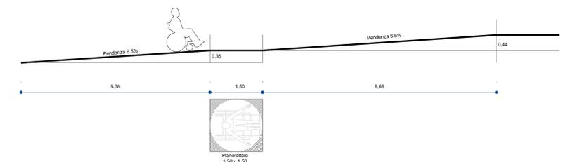
SCHEMA DELLE PENDENZE DEL PERCORSO SEZIONE AA
