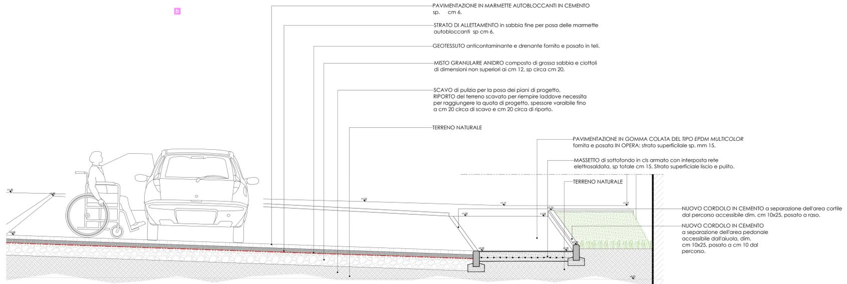
PARTICOLARE 1 - SEZIONE BB CON STRATIGRAFIA DELLE PAVIMENTAZIONI
