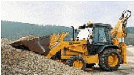
Trattasi della movimentazione del terreno mediante l'ausilio di specifiche macchine per effettuare riempimenti, spostamenti e rilevati dettati dallo schema del progetto esecutivo.
